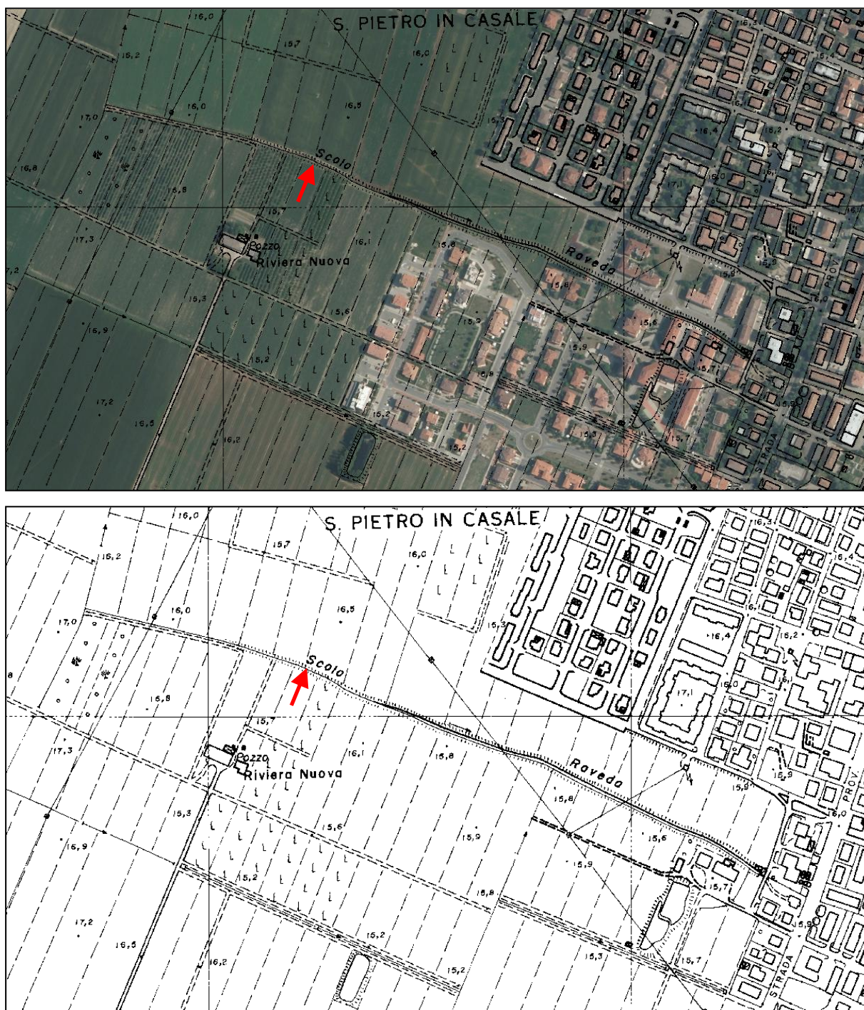
Figura 3 – Rappresentazione del punto di scarico delle acque meteoriche nel recapito finale.
